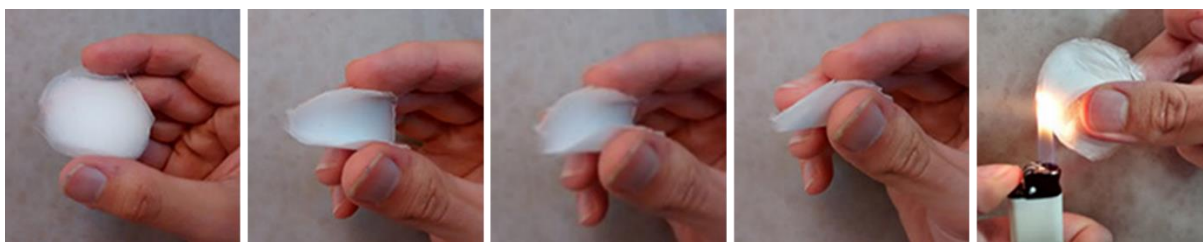
Figuur 20. Flexiramics is keramiek materiaal uit nano-vezels dat flexibel is maar niet brandt. Bron: http://www.eurekite.com/
