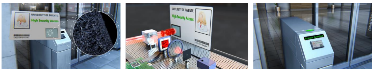
Figuur 27. Plaatjes van een Quantum Secure Authentication systeem met een toegangspas die gebruik maakt van een natuurlijk licht-verstrooiend materiaal. Bron: COPS groep, Universiteit Twente 27
